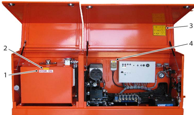
Hydrauliekolie- en ventielen/elektracompartiment
