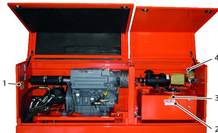
Dieselmotor- en centraal vetsmeersysteemcompartimenten
